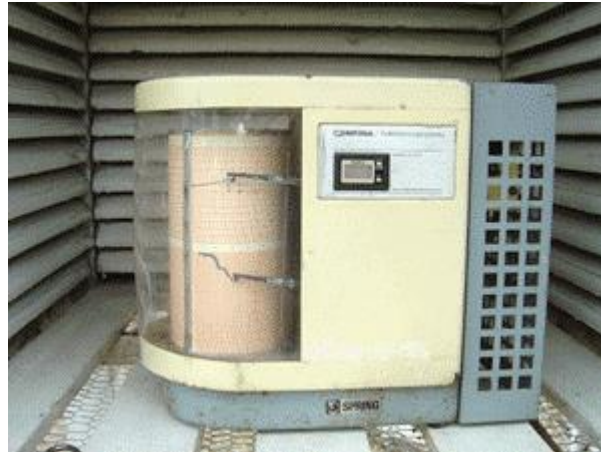
ภาพที่ 7.5 เทอร์โมกราฟ (Thermograph) ที่มา : ศูนย์อุตุนิยมวิทยานครสวรรค์, 2561 : online
