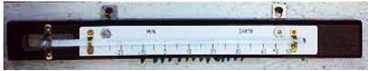
b) เทอร์โมมิเตอร์วัดอุณหภูมิต่ำสุด
