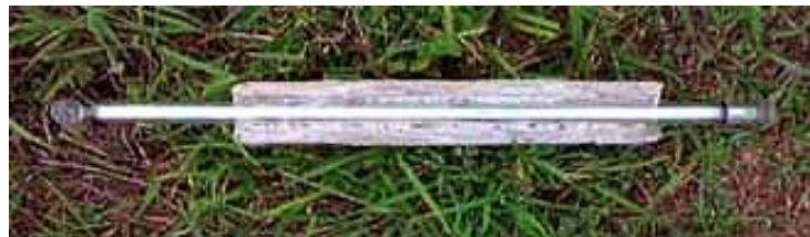
ภาพที่ 7.4 เทอร์โมมิเตอร์ต่ำสุดยอดหญ้า
