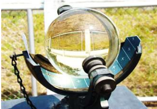
ภาพที่ 7.2 เครื่องวัดแสงแดดแบบลูกแก้ว ชนิดแคมป์เบลสโตกส์ (Campbell-Stokes Recorder)
