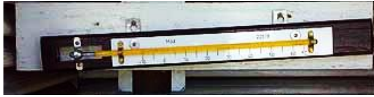
a) เทอร์โมมิเตอร์วัดอุณหภูมิสูงสุด
